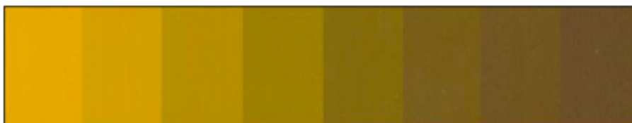
Figura 2: Tiras irradiadas com: 0 mGy (não irradiada); 150/ 500/ 1000/ 2000/ 3000/ 4000 e 5000 mGy, respectivamente [SILVA et al. , 2010].
